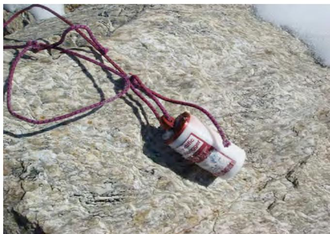
Figure 14: Les capteurs liés à la ficelle sont placés dans le glacier rocheux. Photo : G. Ramelli.
