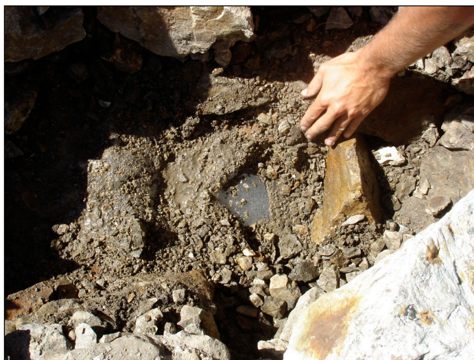
Figure 5.18: Niveau de glace massive atteint lors de l'excavation (environ 60cm) réalisée au glacier de l'Enclave en août 2009.
