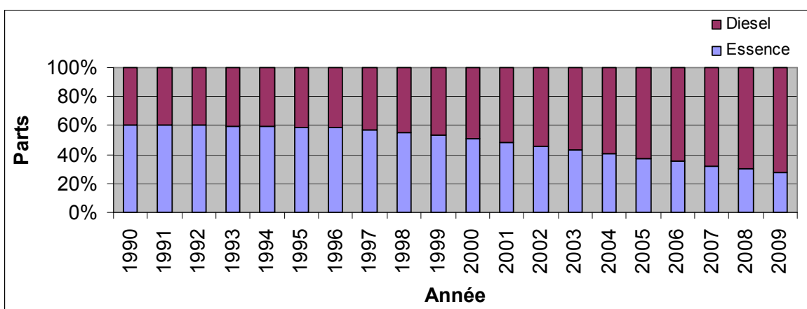
Figure 4.20 Dieselisation du parc des véhicules de transport de choses en Suisse de 1990 à 2009
