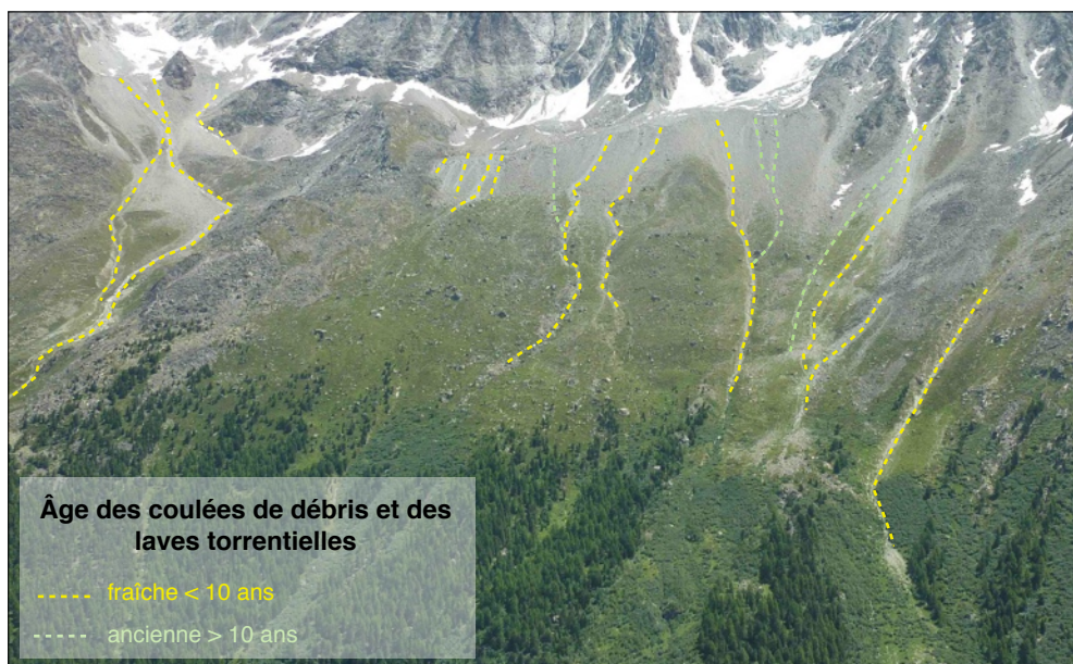
Fig. 5.25 Traces des différentes coulées de débris et laves torrentielles du versant. Leur âge a été déterminé à l'aide de l'observation des photos aériennes actuelles (Google Earth, 2011) et de 1999 (Swisstopo, 1347-11).
