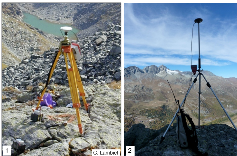
Fig. 3.3 Le GPS différentiel avec sa base (1) et sa partie mobile (rover) (2).
