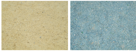
Figure 30 : Poussier de gravier du Jura (à gauche) et gravier de verre (à droite), Source : Florence Rey, 06.05.2011
