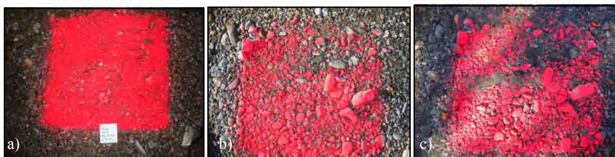
Figure 7.40 - Séquence d'images montrant la méthode appliquée pour l'évaluation du transport sédimentaire. La première image (a) a été prise le 26 octobre 2010 à 07:00, avant l'arrivée de la crue artificielle. La deuxième image (b) a été prise le 27 octobre 2010 à 14:30 et la troisième photo (c) le 28 octobre 2010 à 12:30. La présence d'un faible transport sédimentaire est remarquable à la station de Cama.
