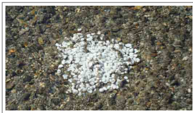
Figure 6.8 – Matériaux utilisés pour l'évaluation du transport de la charge de fond. Cette technique reste purement qualitative.
