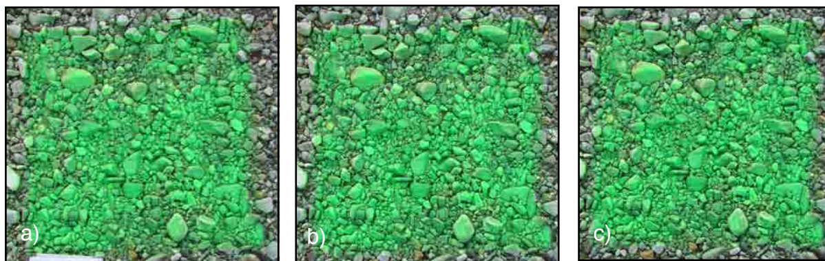
Figure 7.45 - Séquence d'images prises à Cama le 20 février 2011 à 14:00 (a) ; le 21 février 2011 à 14:00 (b) et le 25 février à 14:30 (c). Le transport de la charge de fond est négligeable.
