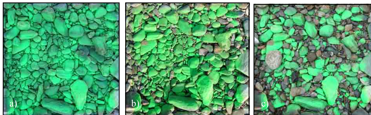
Figure 7.54 - Séquence d'images mettant en évidence le transport sédimentaire. La première image (a) a été prise le 21 février 2011 à 14:30 ; la deuxième image (b) le 25 février 2011 à 14:30 et la troisième image (c) le 13 mars 2011 à 15:00. Nous soulignons la présence d'érosion et de transport de la charge solide.
