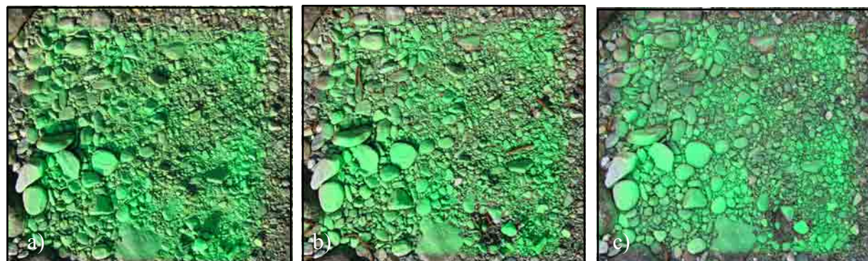
Figure 7.46 - Séquence d'images prises à Grono montrant que le transport de la charge de fond est négligeable. La première image (a) a été prise le 20 février 2011 à 14:30, la deuxième image (b) le 21 février 2011 à 14:30 et la troisième image (c) le 25 février à 11:30.
