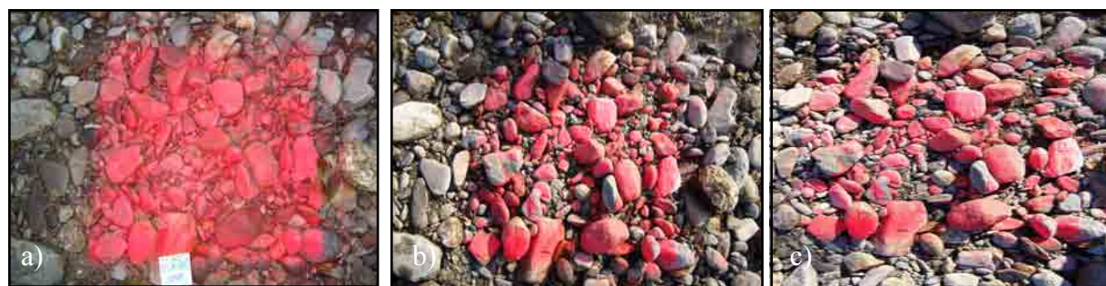
Figure 7.50 - Séquence d'images prises le long de la Morobbia montrant une activité sédimentaire importante. L'image (a) a été prise le 27 octobre 2010 à 07:45, l'image (b) le 27 octobre 2010 à 15:45 et l'image (c) le 29 octobre 2010 à 14:00.
