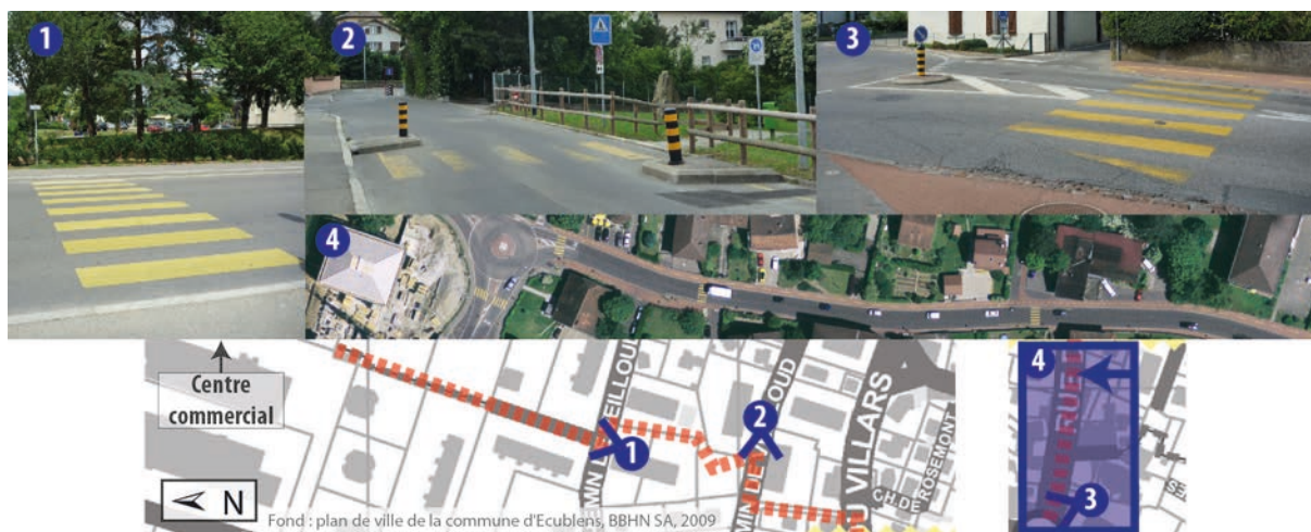
Figure 19 : Infrastructure de traversée au sud
