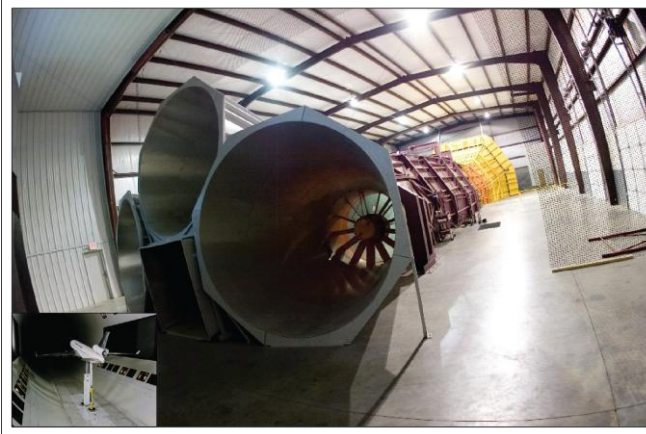
Figure II.1: tunnel du vent de simulation des conditions climatiques (d'après NASA, 2010)
