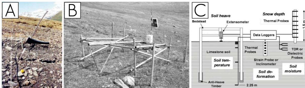
Fig. 4.6. Exemple d'application des méthodes d'inclinométrie et de monitoring. A) Inclinomètre de type « Morand » sur un lobe du bassin versant de la Grande Sassièrre (FR), (Rolin, 2001). B) Photo d'un système de monitoring installé en Norvège (Harris et al., 2008). C) Représentation schématique d'un système de monitoring semi-automatique, montrant les différents instruments de mesure combinés (Matsuoka, 2010).
