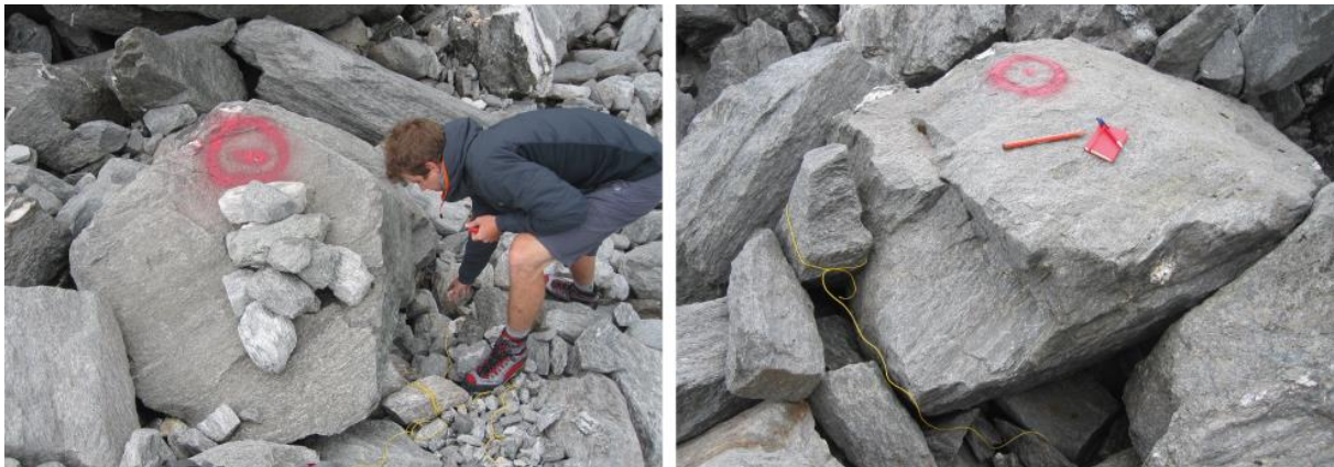
Fig. 2.12 : Capteur de température attaché à une ficelle posé entre des cailloux (gauche) et pendant sous un gros bloc dans une cavité (droite)
