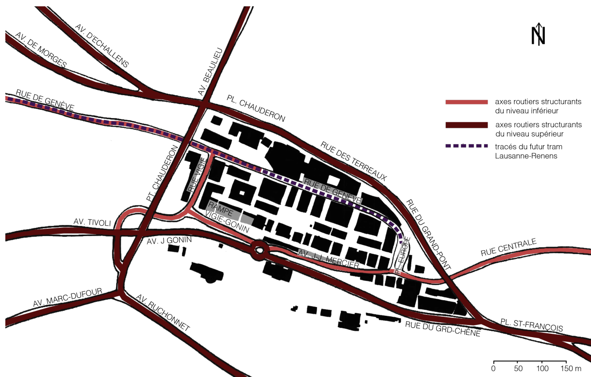
Figure 4 : schéma de la situation routière future de la plateforme du Flon (Source : réalisation Mara Lepori à partir d'un fond de plan du Guichet cartographique de la Ville de Lausanne)
