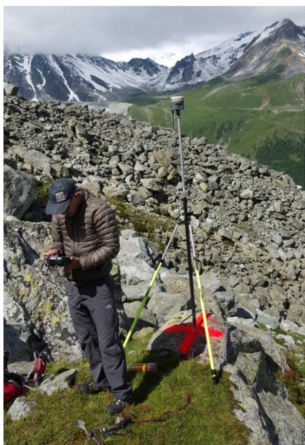
Figure 6. Marquage et mesure des points de contrôle en dehors du glacier rocheux.
