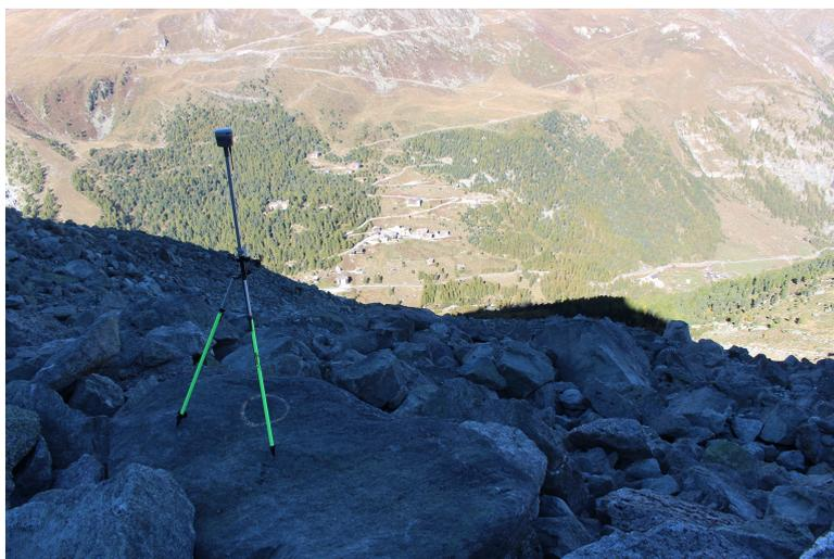
Figure 4. Récepteur mobile dGPS sur un point de validation. Vue sur le village d'Arolla.
