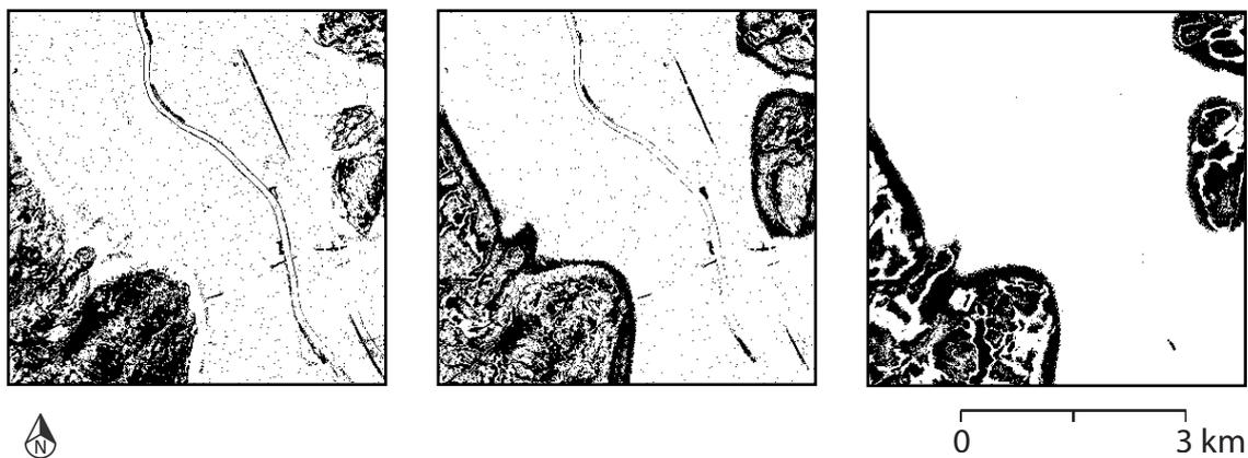
**Figure 40 :** Illustrations des endroits où les résultats du *downscaling* sont les moins bons, à partir d'un nombre de voisin maximum de 10 et d'un seuil (de gauche à droite) de 0.01, 0.04 et 0.1.
