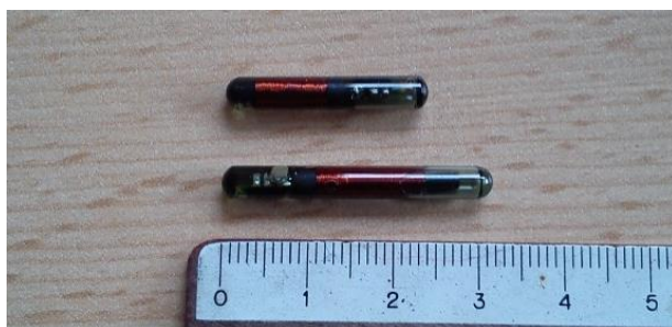
8: Les éléments sont composés d'une petite antenne, d'un condensateur, d'une pièce de résonance et d'un petit circuit, le tout contenu dans une capsule en verre et totalisant une longueur de 23 mm ou 32 mm.
