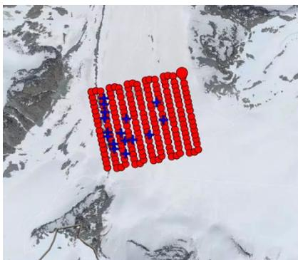
Figure 3 : lignes de vol visibles en rouge sur le logiciel Pix4D. Les cibles sont représentées par les croix bleues. Celles sur la moraine latérales n'ont pas été retenues pour l'analyse finale.
