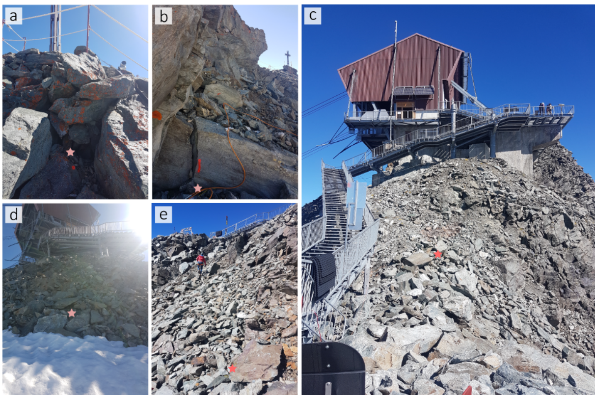
Figure 13. Photos de l'emplacement des capteurs de températures à la surface du sol (dans des zones de débris ou de roches fracturées) : a) MF3 ; b) MF5 ; c) MF7 ; d) MF2 ; et e) MF8.
