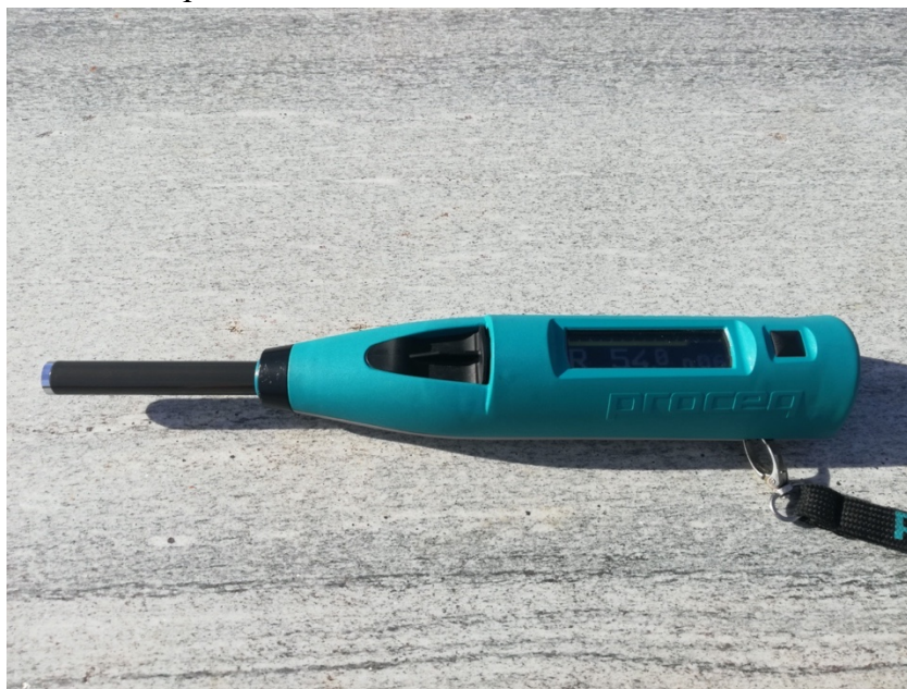
Figure 12: Rock Schmidt utilisé pour les mesures des valeurs-R sur les glaciers rocheux. Photo de Meris, 2020.
