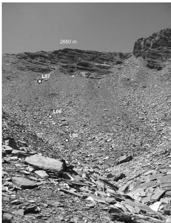
Fig. 7.37 : Vue frontale du cône principal de l'éboulis de Gana Rossa, avec l'emplacement des trois capteurs autonomes de température. Les profils géophysiques aval-amont ont été effectués dans la partie à granulométrie plus fine au centre du cône, tandis que les capteurs de température ont été placés légèrement à côté afin d'avoir une granulométrie assez grossière pour en garantir la protection.
