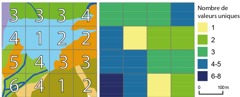
Figure 31 : La statistique variété calcule le nombre de valeurs uniques par cellules de 100m x 100m.
