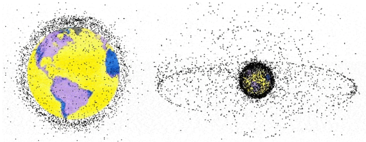
Figure 2.2 L'image de gauche représente environ 7'000 débris autour de la Terre entre 800 et 1'500km d'altitude. L'image de droite représente les 8'500 objets d'origine anthropique supérieurs à 10 cm présents jusqu'à l'orbite géostationnaire. En 1999, seul 7 % d'entre eux sont fonctionnels ( http://system.solaire.free.fr/sondeterre5.htm#debris )
