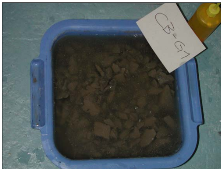
Photo 18 : Echantillon CB-G1 quinze minutes après avoir été secoué (Photo : Kim Pieracci).
