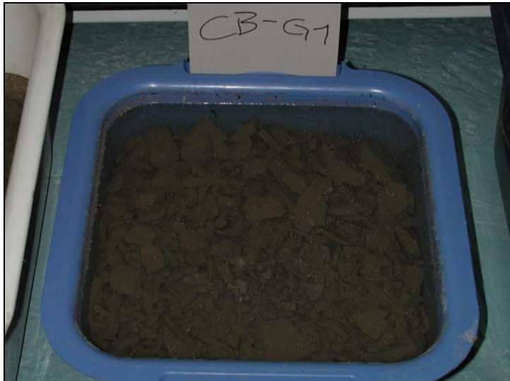
Photo 16 : Echantillon CB-G1 noyé dans l'eau depuis quelques jours (Photo : Kim Pieracci).
