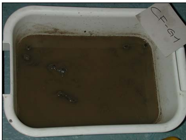
Photo 43 : Echantillon CF-G1 quinze minutes après avoir été secoué (Photo : Kim Pieracci).
