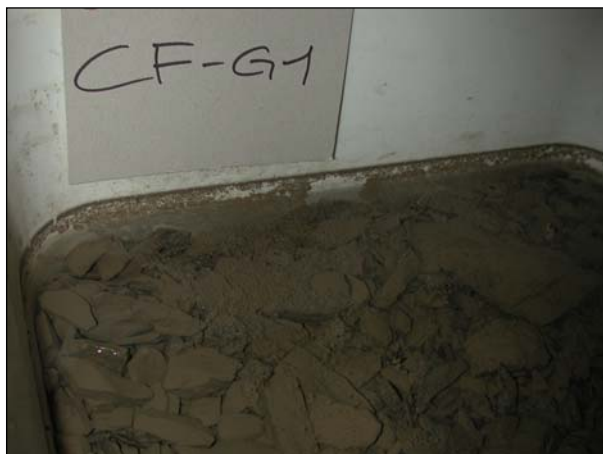
Photo 41 : Echantillon CF-G1 noyé dans l'eau depuis quelques jours (Photo : Kim Pieracci).
