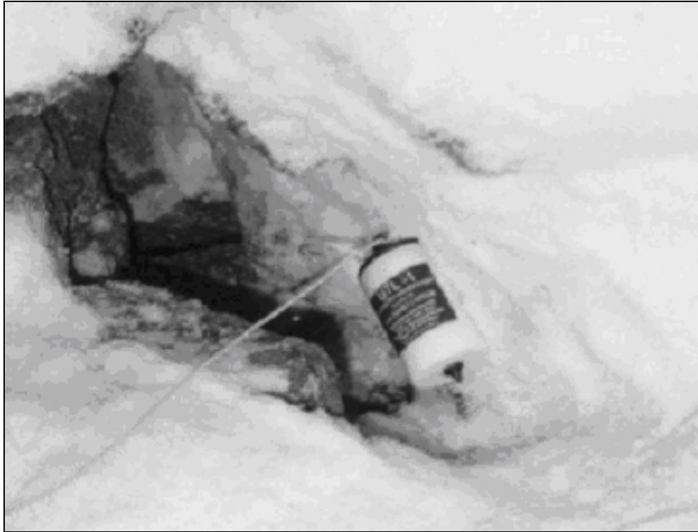
Photo 2 : Exemple de mini-logger UTL-1 (Photo : DELALOYE, 2004).
