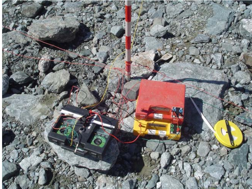
Figure 16 : matériel de géoélectrique (voltmètre, ampèremètre, piles, cables)
