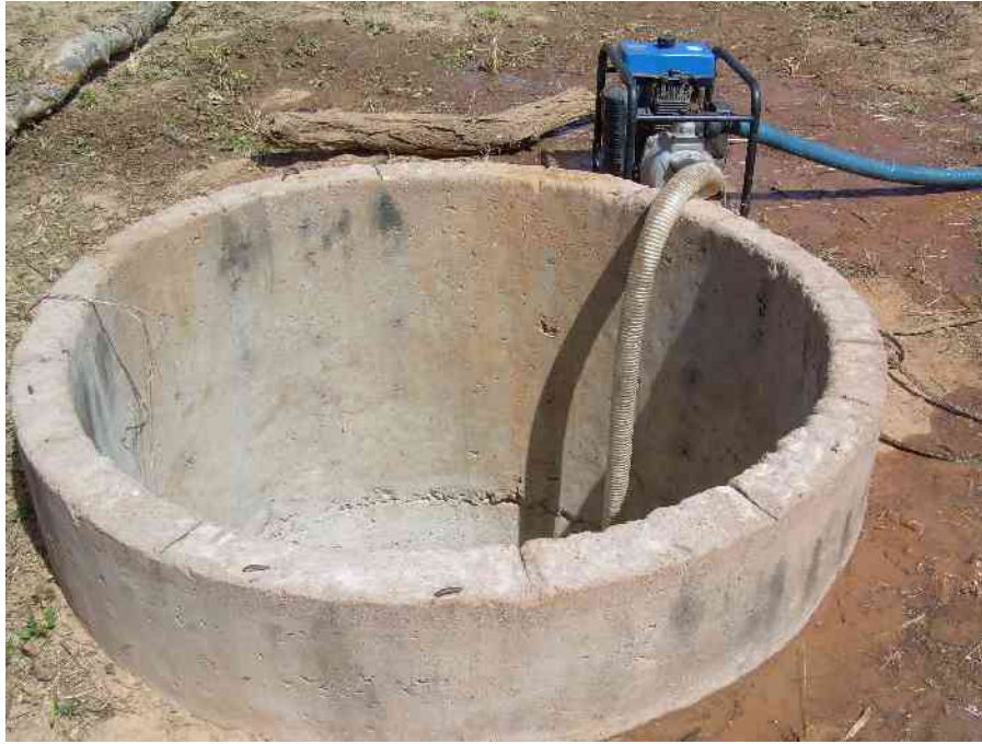
Photo : irrigation à partir d'un puits maraîcher – exhaure par motopompe Source : J.Cochand, enquête de terrain, 2006-2007
