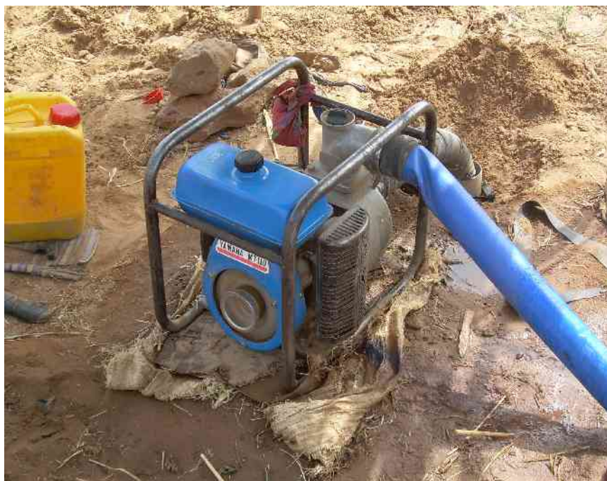
Photo : motopompe, 3.5 CV – utilisée comme système d'exhaure de l'eau Source : J.Cochand, enquête de terrain, 2006-2007
