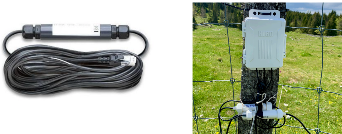
Figure 60. Câbles de liaison entre les compteurs et les enregistreurs de données sur les alpages du Bucley/Pré d'Etoy et de la Perroude de Vaud (Photos : Bakrona Zürich AG ; Lorena Roulin)
